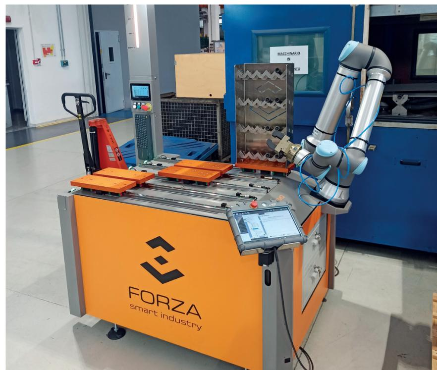
Flexy è un magazzino automatico polivalente per il carico e scarico automatico di torni, frese e piccole linee di assemblaggio, collaudo e misura.
